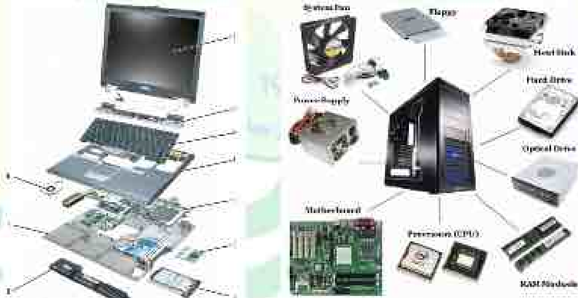
تشابه مكونات أجزاء الحاسب الشخصي بنوعيه المكتبي Desktop والمحمول Laptop
